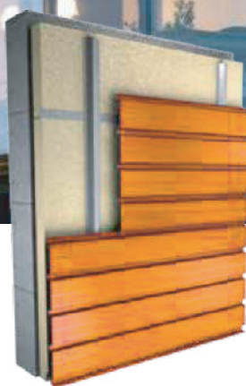
FASADNO PROFILISANJE PRIMER HORIZONTALNE MONTAŽE
